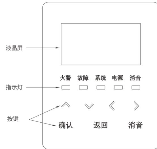
图1 探测器显示及操作面板示意图
